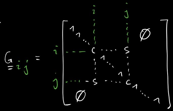
"Drehung in mathematisch positiver Richtung in der Ebene, welche von i-ten & j-ten Basisvektor aufgespannt wird."
