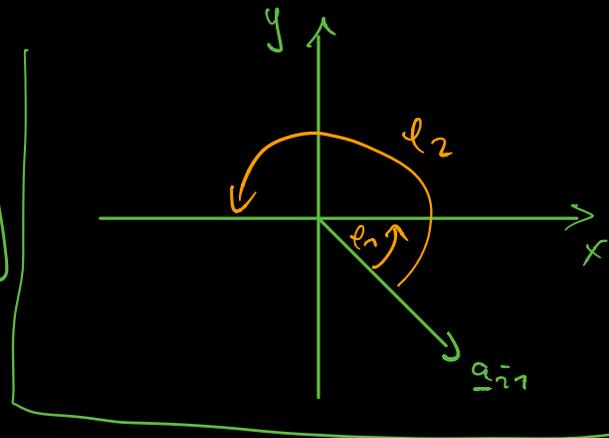
$$\underline{R} = \underline{G} \cdot \underline{A} = \begin{bmatrix} \cos \varphi & \sin \varphi \\ -\sin \varphi & \cos \varphi \end{bmatrix} \cdot \begin{bmatrix} 1 & 3 \\ -1 & 4 \end{bmatrix}$$
